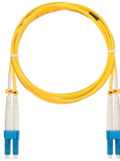
NMF-PC2S2C2-LCU-LCU-xxx SM 9/125 OS2, LC/UPC-LC/UPC, LSZH, D=2.0мм, двойной
