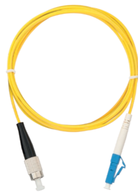
NMF-PC1S2C2-FCU-LCU-xxx SM 9/125 OS2, FC/UPC-LC/UPC, LSZH, D=2.0мм, одинарный
