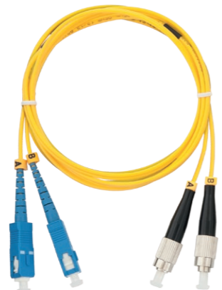
NMF-PC2S2C2-SCU-FCU-xxx SM 9/125 OS2, SC/UPC-FC/UPC, LSZH, D=2.0мм, двойной
