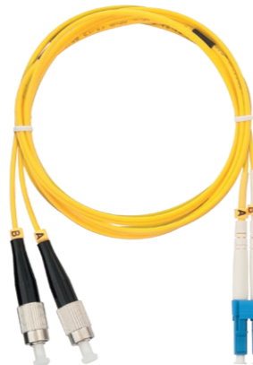
NMF-PC2S2C2-FCU-LCU-xxx SM 9/125 OS2, FC/UPC-LC/UPC, LSZH, D=2.0мм, двойной
