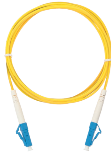
NMF-PC1S2C2-LCU-LCU-xxx SM 9/125 OS2, LC/UPC-LC/UPC, LSZH, D=2.0мм, одинарный
