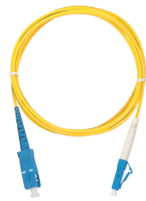
NMF-PC1S2C2-SCU-LCU-xxx SM 9/125 OS2, SC/UPC-LC/UPC, LSZH, D=2.0мм, одинарный
