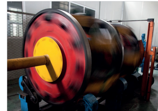
Процесс повива брони из стальных проволок
