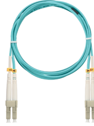
NMF-PC2M3C2-LCU-LCU-xxx MM 50/125 OM3, LC/UPC-LC/UPC, LSZH, D=2.0мм, двойной
