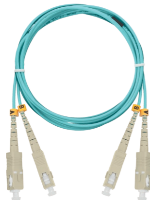
NMF-PC2M3C2-SCU-SCU-xxx MM 50/125 OM3, SC/UPC-SC/UPC, LSZH, D=2.0мм, двойной
